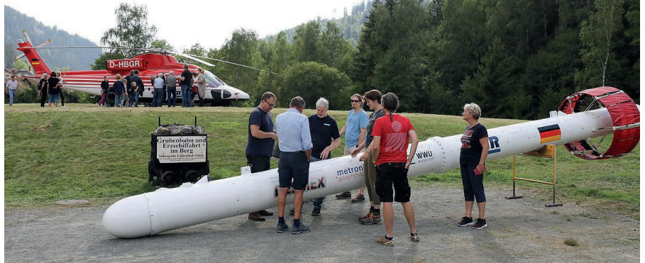
Die weiße Flugsonde mit Messtechnologie wird vom Hubschrauber an einem Seil in 50 bis 70 Metern Höhe über dem Boden transportiert.
