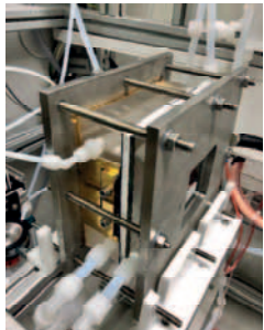
Abbildung 1: Laborreaktor für die radikalische Wasserreinigung.
