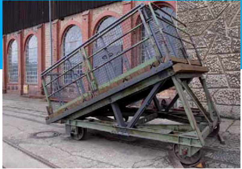
Bereits restauriert: der Schrägförderwagen, der künftig bis zu 15 Besucher transportieren kann. Im Zuge der Wiederherstellung ist die Nutzlast von einst 6,5 auf 3 Tonnen reduziert worden.
