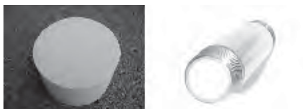
Bild 2: Wabenkörper aus monolithischem Compositmaterial (links), monolithischer Stab eingesetzt in ein Edelstahlgehäuse (rechts) Durchmesser des Monolithen ca. 7,5 cm; Durchmesser des Edelstahlreaktors 2,4 cm; Länge des eingesetzten porösen Monolithen 11 cm
