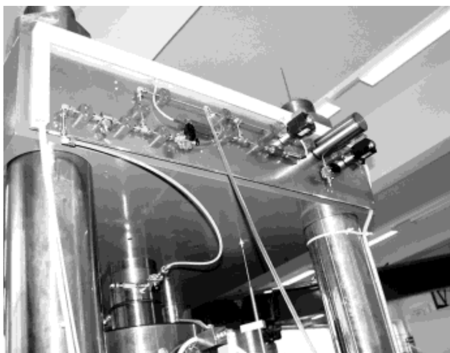
Bild 18: Meßsystem zur Ermittlung von Gasflüssen in Triaxialversuchen
