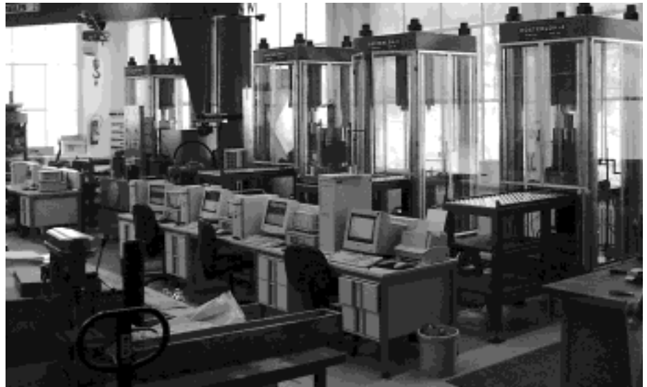
Bild 6: Prüfstände für triaxiale Festigkeits- und Kriechversuche
