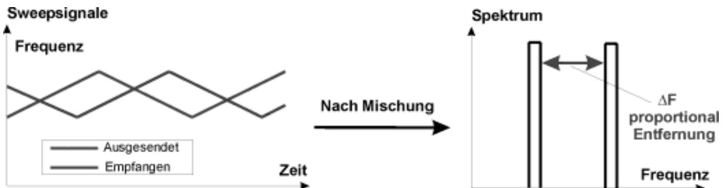
FMCW-Prinzip zur Entfernungsmessung
