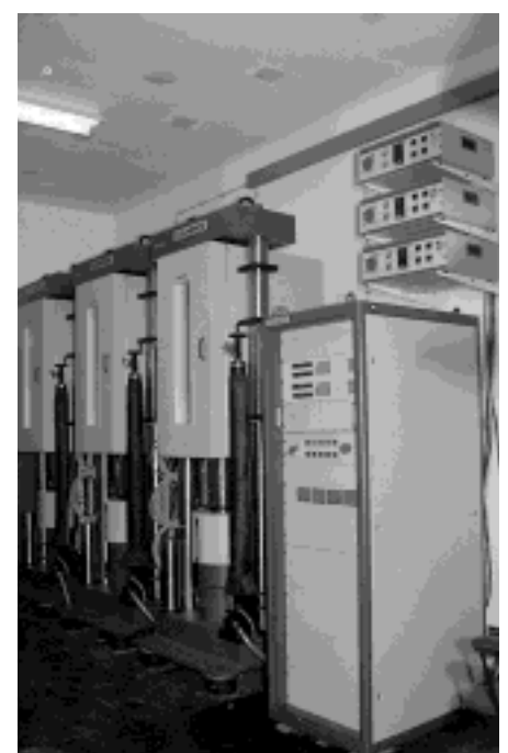
Bild 4: Prüfstand für Kriechversuche (einaxial)
