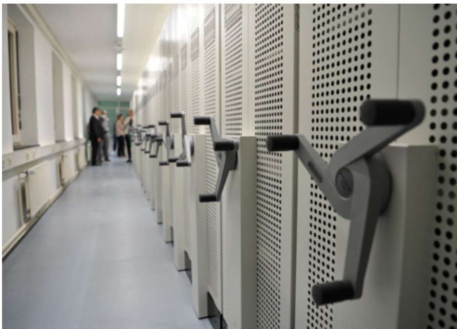
Das Universitätsarchiv verfügt seit Mitte 2022 über einen neu geschaffenen Magazinraum mit modernem Rollregalsystem.
