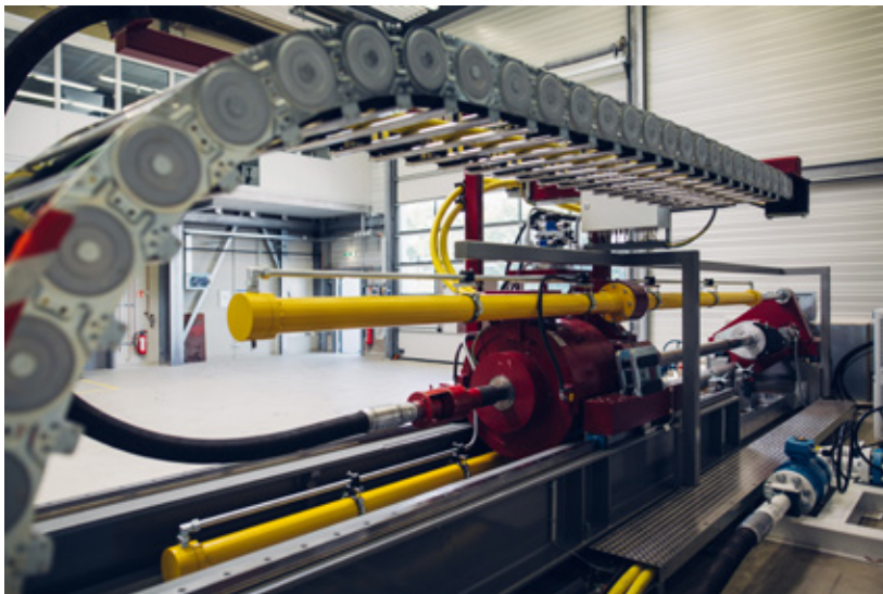
Der Hardware-Simulator des DSC wird derzeit umfassend erweitert, um untertägige Schwingungen des Bohrstrangs realitätsnah abbilden zu können.
