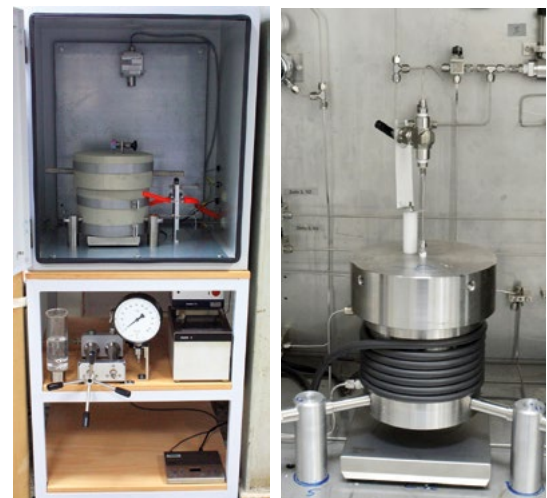
Abbildung 4: Prototyp des HPHT-Autoklavs in der explosionsgeschützten Ausführung für Wasserstoffanwendungen (H 2 STORE Projekt) und Aufbau einer neuen HPHT-Zelle
