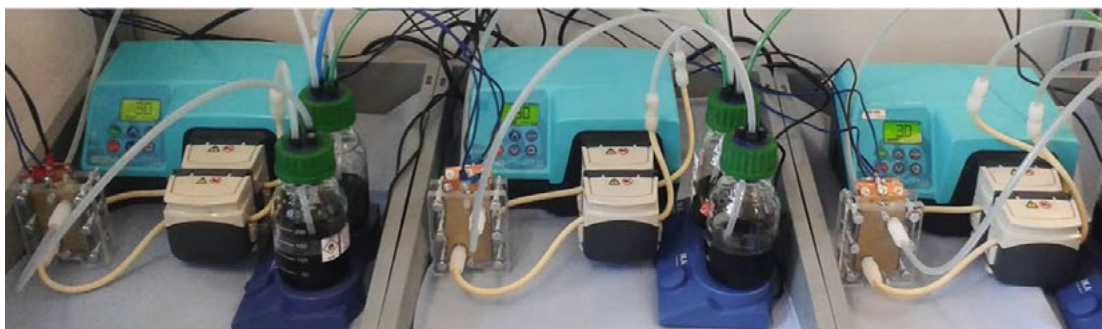
Abbildung 4: Parallelisierte Materialuntersuchungen mit Einzelzellen mit 10 cm 2 akt. Fläche
