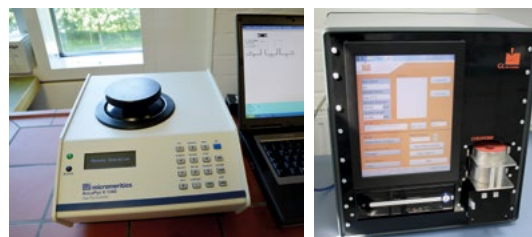
Abbildung 3: Gaspycnometer AccuPyc 1340 für die Bestimmung der Porosität von Gesteinsprobekörpern unter Laborbedingungen (links) und Gaspermeameter SYROPERM für die Bestimmung der Permeabilität der Probekörper unter Laborbedingungen (rechts)
