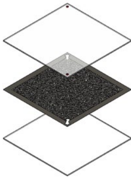
Abbildung 3: links: Struktur eines Glas-Silizium-Glas Mikromodell [1]; rechts: Mit zwei Phasen gesättigtes Mikromodell, braun = gasförmige Phase, grün = wässrige Phase
